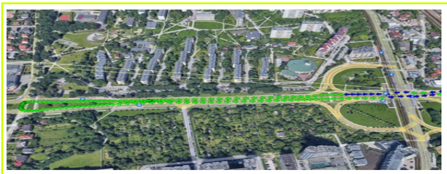
wynik naszego testu w aucie: zielony: rozwiązanie RTK; niebieski: DGPS (pod estakadą)
