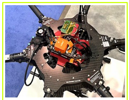
UAV przygotowany pod IMU X3 FOG
