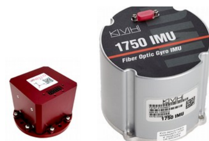
FOG X3 w porównaniu do FOG KVH-1750
