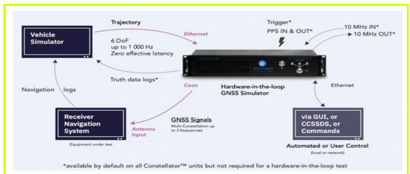
konfiguracja systemu do testów „hardware-in-the-loop”
